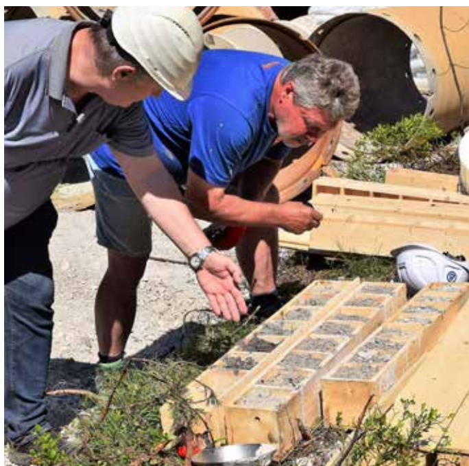
Dokumentation der Gesteinsproben: Der Grundwasserkörper (55m Tiefe) befindet sich unter einer Lehmschicht (30m)
